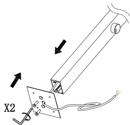
3、将连接件插头与灯杆插头对插连接;
