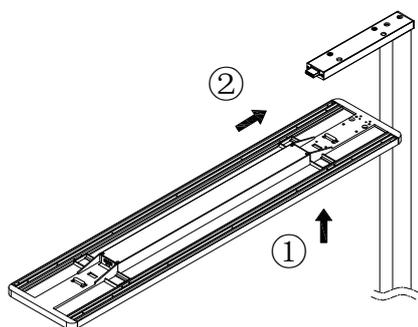
6、将连接件与两个灯头用螺丝定。
