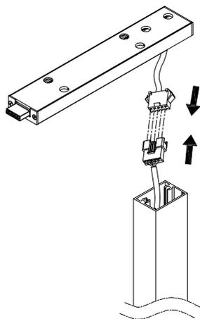
4、将连接件与灯杆用两颗螺丝固定。
