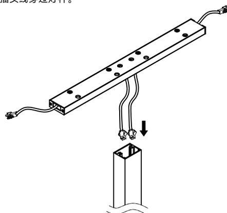
3、将连接件与灯杆用两颗螺丝固定。
