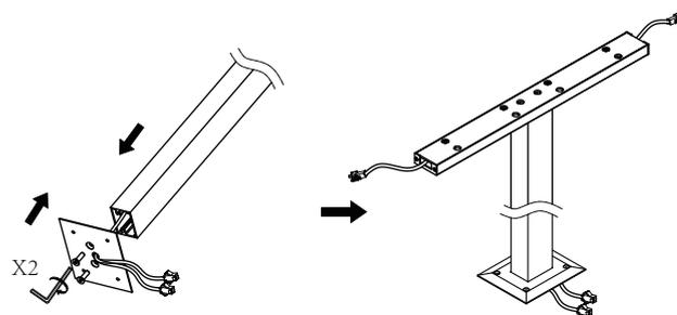
5、① 将两个灯头插头线与连接件插头线对插连接
