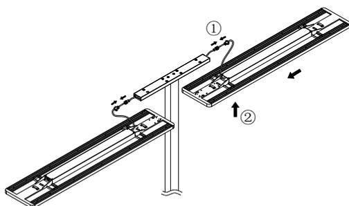
6、将连接件与两个灯头用螺丝固定。
