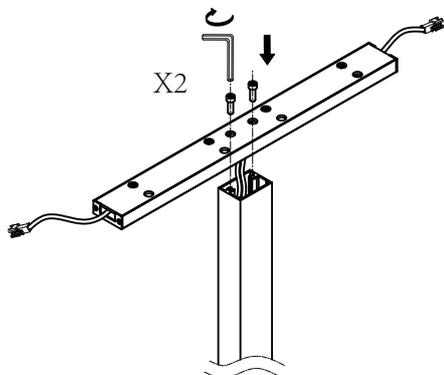
4、将灯杆插头线穿过固定块用两颗螺丝固定。
